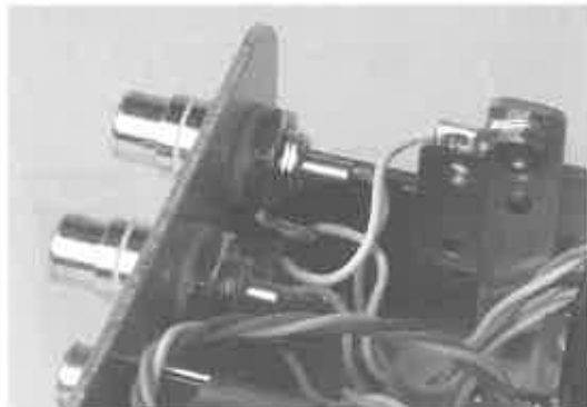
《写真G》 ケースへは、シャーシ取付け金具を使ってグラウンド・アースをとる
