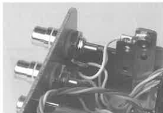
《写真G》 ケースへは、シャーシ取り付け金具を使ってグラウンド・アースをとる
