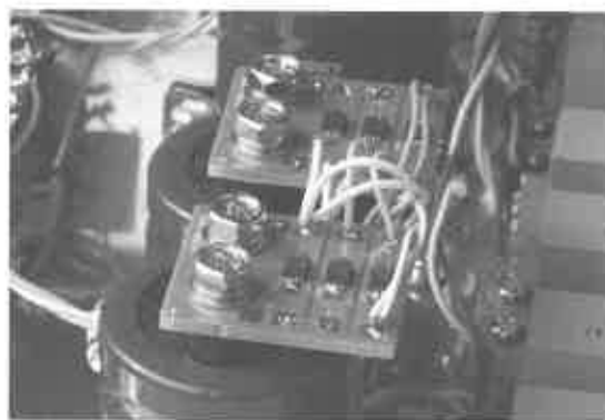
《写真 C》ハーフ・ブリッジ基板を使ってダイオードとケミコンを接続する
