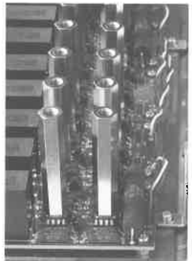
〈写真D〉真鍮スペーサのアド・マスをICに付ける
