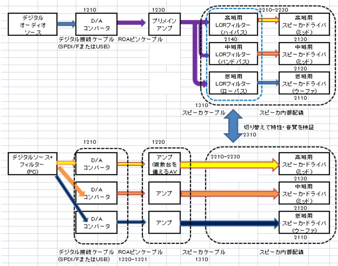
上: デジタル音源のための多重アンプ PC デジタル音響装置プロトタイプの概要
